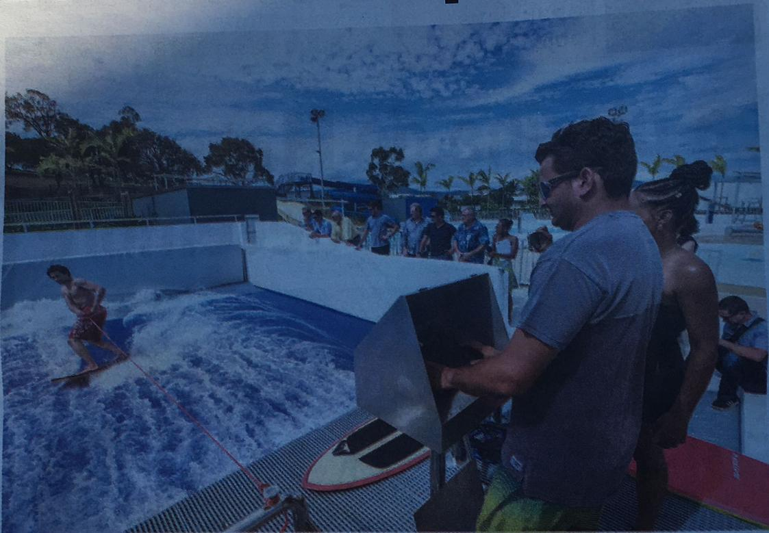
La vague statique, attraction phare du centre aquatique, passe d'un mode à plat à un mode incliné, avec une pente jusqu'à 11 degrés. Jean-Guillaume Argoud, de la société Mada, a conçu cette installation et en fait la démonstration.
