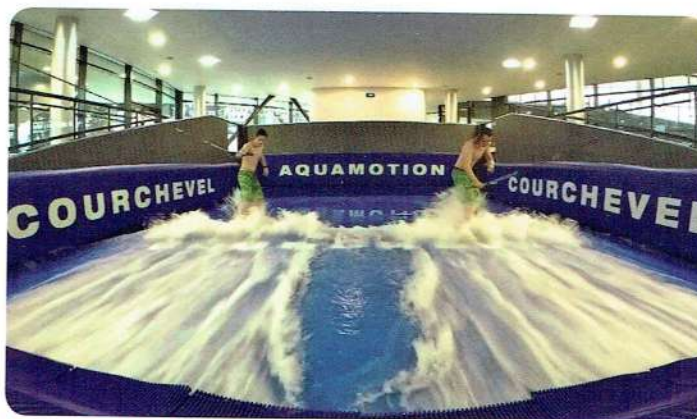
Le surf par Madéa : un système intégré dans le sol ou dans un bassin, à une, deux ou trois pistes, sur une zone de glisse à plat pouvant également être inclinée. Les vagues sont modulables et évolutives. Ici la conception offre 2 pistes sur 8 m de large.
